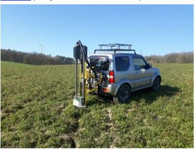
Zur Humusmessung werden GPS-gesteuert Bodenproben gezogen. Eine Probe basiert auf mindestens fünfzehn Einstichen je Referenzfläche in 25 – 30 cm Tiefe. Die erste Bodenprobe wird zu Beginn der Klimapatenschaft gezogen. Nach drei Jahren erfolgt eine zweite Beprobung.
